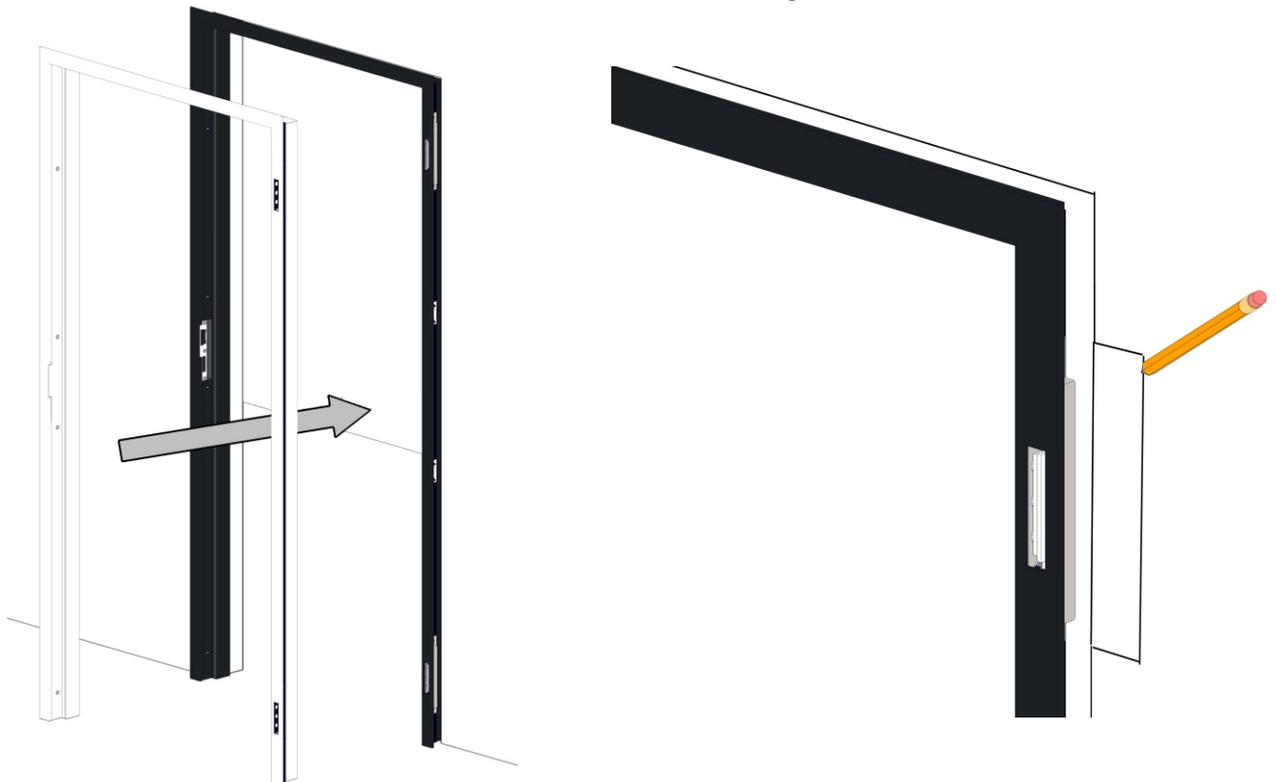
**5.1** ATTENTION, LES DIMENSIONS SUR LE DESSIN SONT ESTIMATIVES. ELLES CONCERNENT LA POSE EN ANGLE AVEC LE JEU DE POSE DE 7 MM EN PARTIE HAUTE ET 11 MM SUR CHAQUE CÔTÉ EN LARGEUR. IL FAUT LES VÉRIFIER PAR RAPPORT À LA PORTE CONCERNÉE. LES MODIFICATIONS SONT POSSIBLES EN FONCTION D'ÉQUIPEMENT DE LA PORTE OU SUITE À DES MODIFICATIONS DE LA CONSTRUCTION OU DE LA TECHNOLOGIE.
